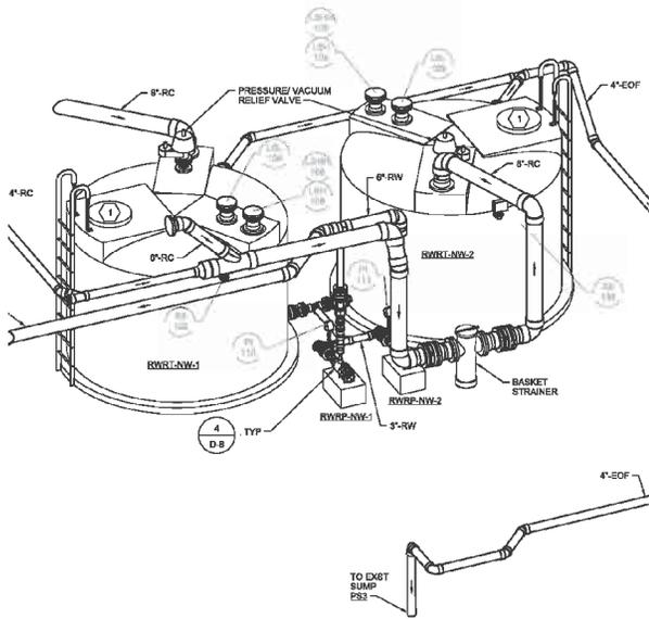
1 NORTHWEST RAINWATER RECEIVER SYSTEM ISOMETRIC
